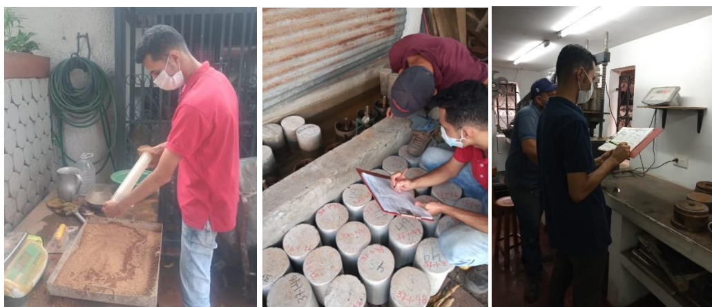
Figura 10. Ensayo de CBR (Norma I.N.V. E – 148-13)
