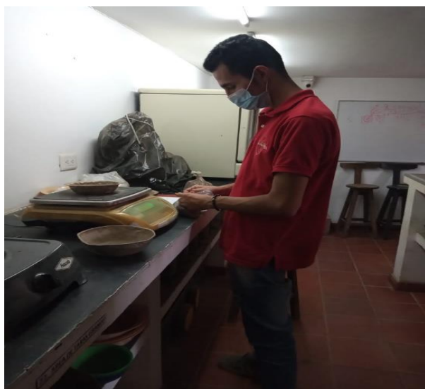
Figura 1. Ensayo de humedad natural (Norma I.N.V. E-122)
