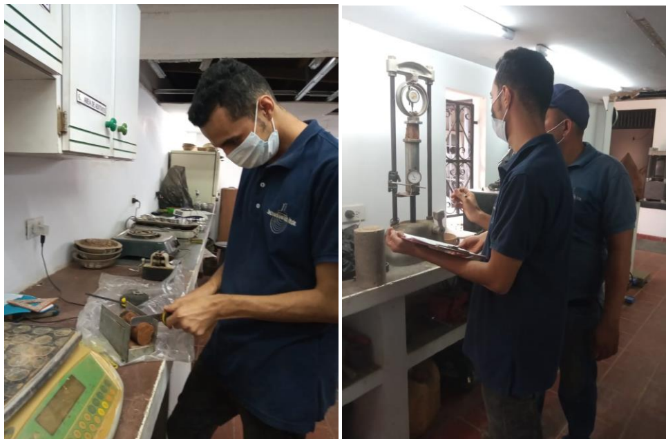
Figura 7. Ensayo de incofinados (Norma I.N.V. E – 152-13)
