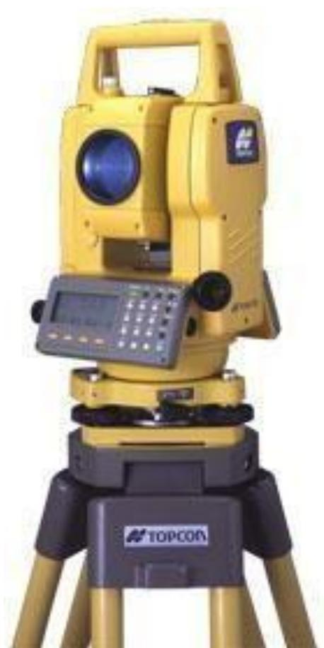
**Figura 1. Estación total electrónica**
