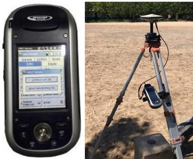
**Figura 3. GPS de precisión y antena topográfica**
