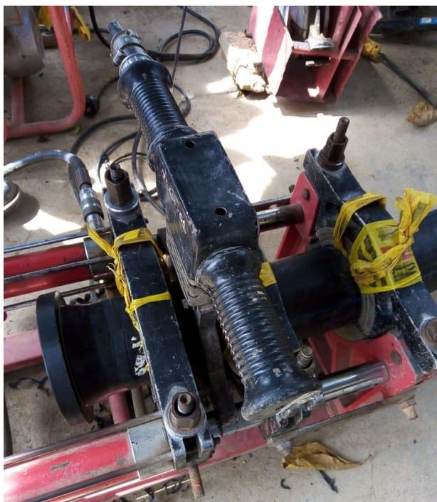
**Figura 14. Kit de termofusión**
