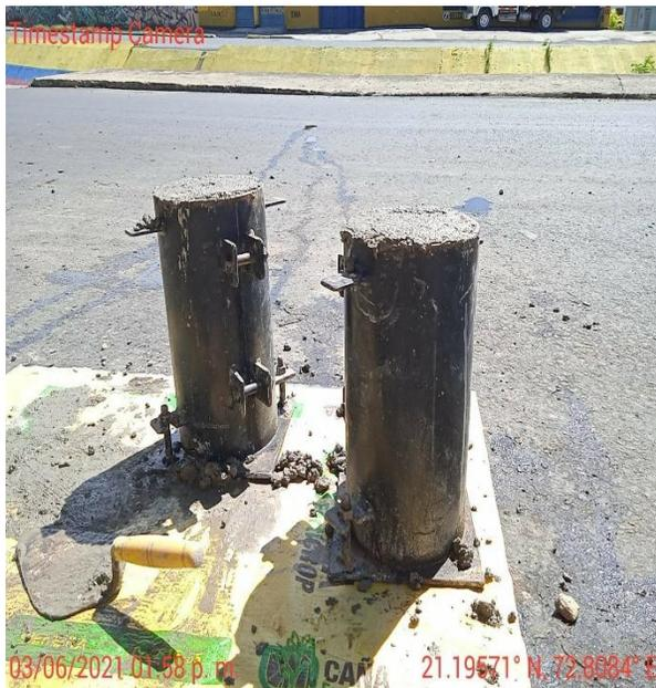
**Figura 41. Resistencia (cilindros)**
