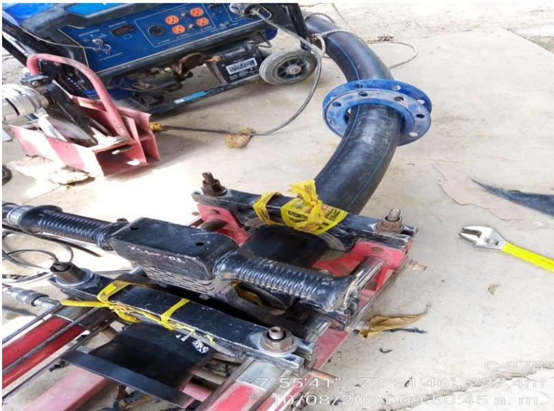
**Figura 29. Planta 240, kit de termofusión (carro alineador, plancha, emparejador, abrazaderas), porta brida y brida loca**
