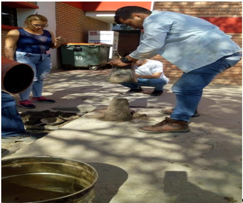
Figura 20. Ensayo de Asentamiento del Concreto
