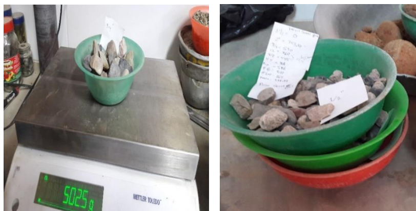
Figura 17. Ensayo de caras fracturadas al agregado grueso
