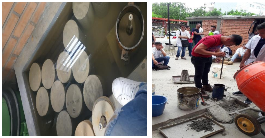
Figura 18. Ensayo de elaboración y curado de cilindros de concreto
