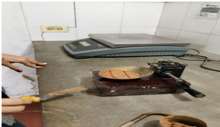
Gráfica 10. Ensayo con Cazuela de Casagrande
