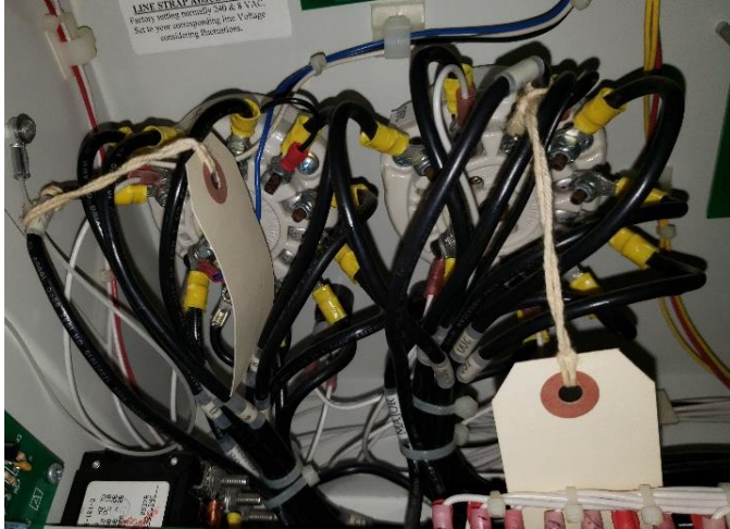
Figura 39. Interruptores selección de kVp.
