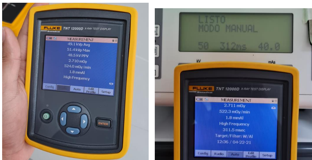
Figura 35. Datos obtenidos con dispositivo Patrón. Autores, Comparación de datos de Equipo rayos x con dispositivo Patrón.
