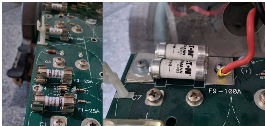
Figura 69. Protecciones de la tarjeta superior 01643
