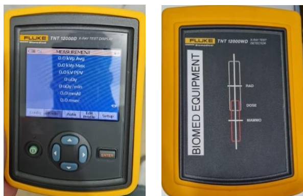
Figura 29. Equipo Patrón Fluke TNT 12000D. Imagen 2. Detector X-Ray Test TNT 12000WD).
