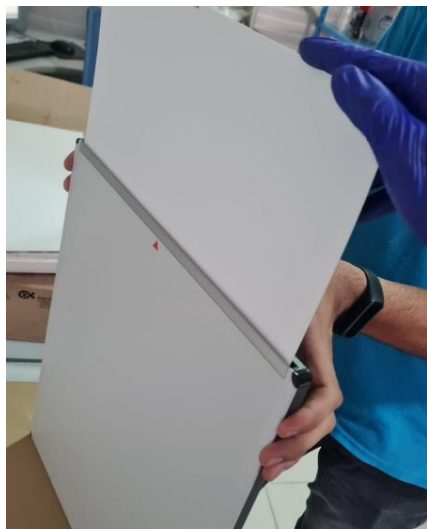
Figura 56. Ajuste Chasis 14"x17" con película de fósforo
