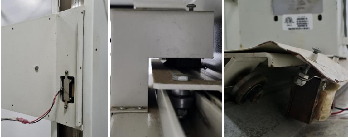
Figura 48. Sistema de frenos por Electroimán
