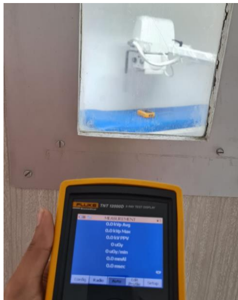
Figura 34. Disparo de rayos x a detector TNT12000WD
