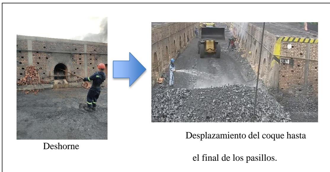
Figura 75. Acopio de coque en la vía principal
