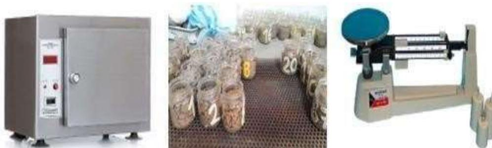
*Ilustración 2. Equipos utilizados en el ensayo de INV E – 122 – 13*
