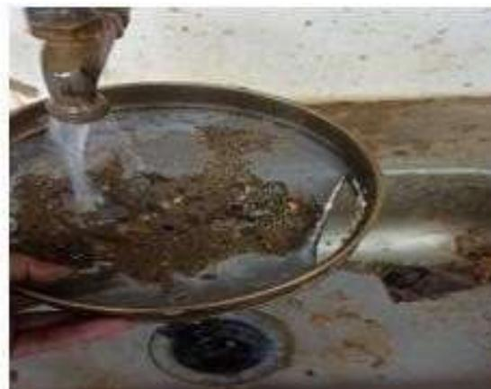
*Ilustración 5. Realización del ensayo INV E - 214 - 13*
