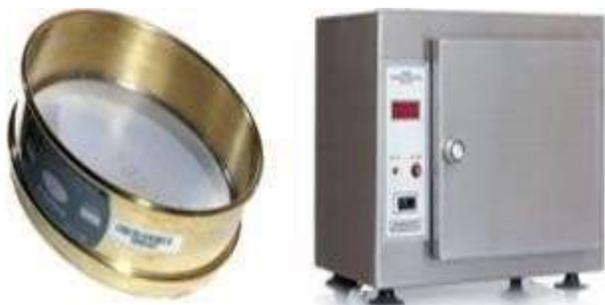
*Ilustración 4. Equipos utilizados en el ensayo INV E - 214 - 13.*
