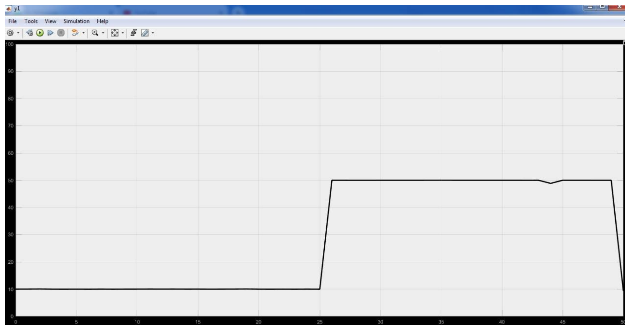
Figura 53. Comprobación a través de la red neuronal del motor en estado de falla por vibración
