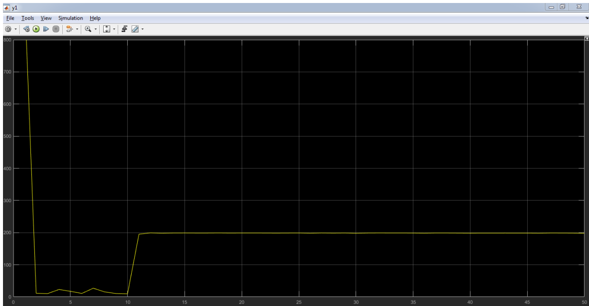
Figura 66. Comprobación a través de la red neuronal del nuevo motor en estado de falla por desbalance de fase 2
