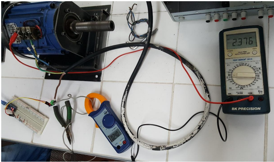
Figura 27. Calibración del sensor de corriente
