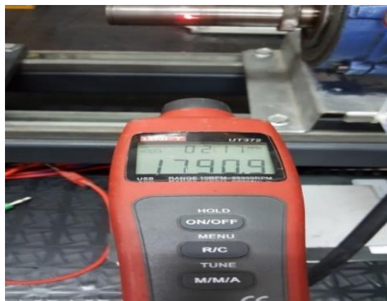
Figura 11. Velocidad del motor en vacío de 1790 rpm
