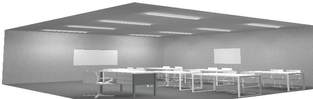
Figura 14. Distribución de luminarias en 3D salón 1
