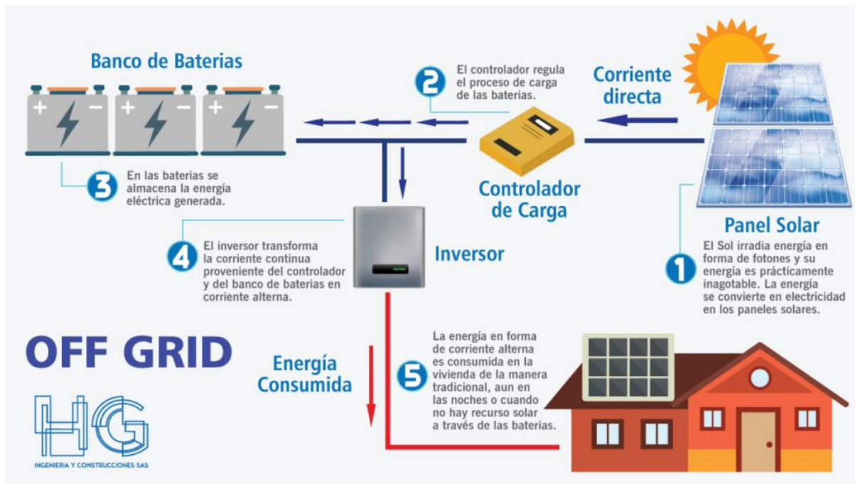
Figura 4. Sistema fotovoltaico Off Grid
