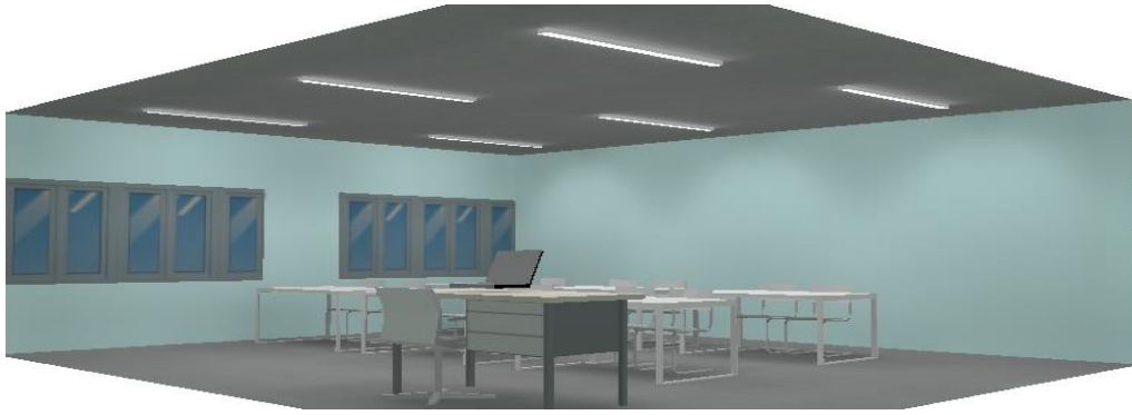
Figura 18. Distribución de luminarias en 3D -salón 2
