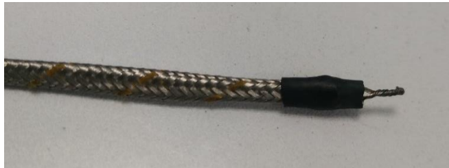
Figura 83. Unión de conductores termocupla
