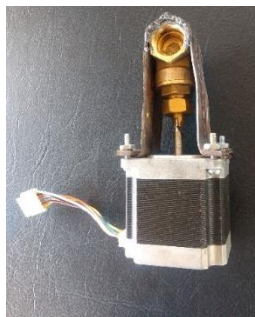
Figura 113. Acople motor paso a paso-cuerpo de la válvula
