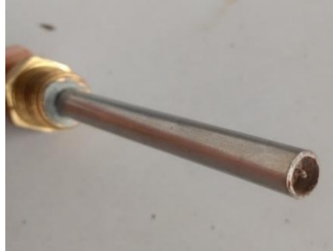
Figura 86. Llenado del termopozo con mortero refractario
