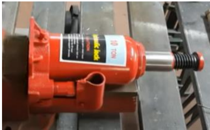
Figura 37. Posición de trabajo del accionado lineal de botella
