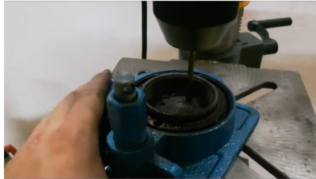
Figura 42. Base del accionador lineal de botella perforado
