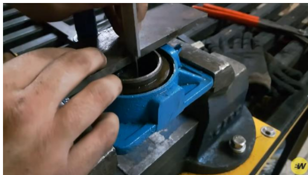
Figura 39. Medición de la profundidad de la cámara de reserva de aceite
