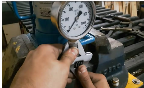
Figura 43. Montaje del manómetro de presión
