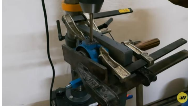
Figura 40. Perforación con ayuda de la fresadora
