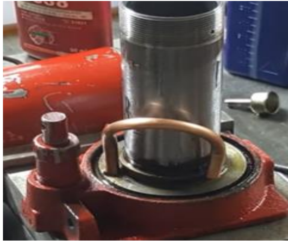
Figura 36. Adaptación de la manguera al accionado lineal de botella
