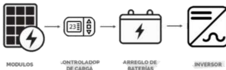
Figura 12. Componentes de un sistema fotovoltaico aislado.
