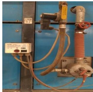
**Figura 26.** Quemador del horno
