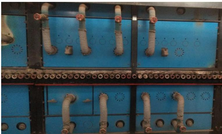
**5.12.4 Sistema de enfriamiento indirecto.** El sistema se compone de tubos intercambiadores de calor, transversales al horno por debajo de la bóveda, a través de los cuales un ventilador aspira y hace circular aire ambiente, una tubería con órganos de regulación manual y automática conecta los tubos intercambiadores de calor.
