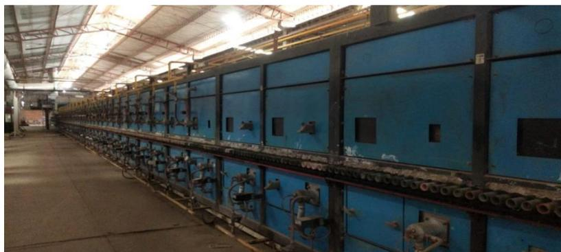
**Figura 10.** Horno de Rodillos # 5 SACMI FMS 2600
