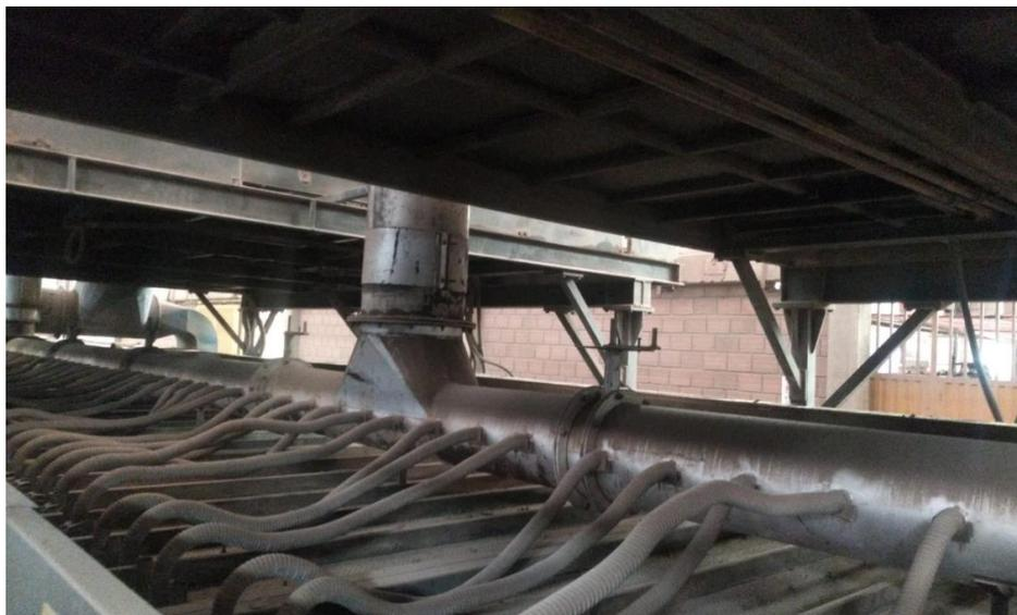
**Figura 41.**Intercambiador de calor enfriamiento indirecto
