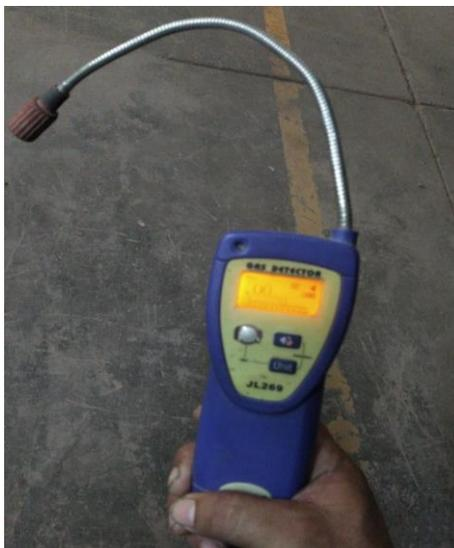
**Figura 83.** Detector de fugas de gas
