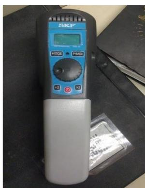
**Figura 53.** Lámpara estroboscópica
