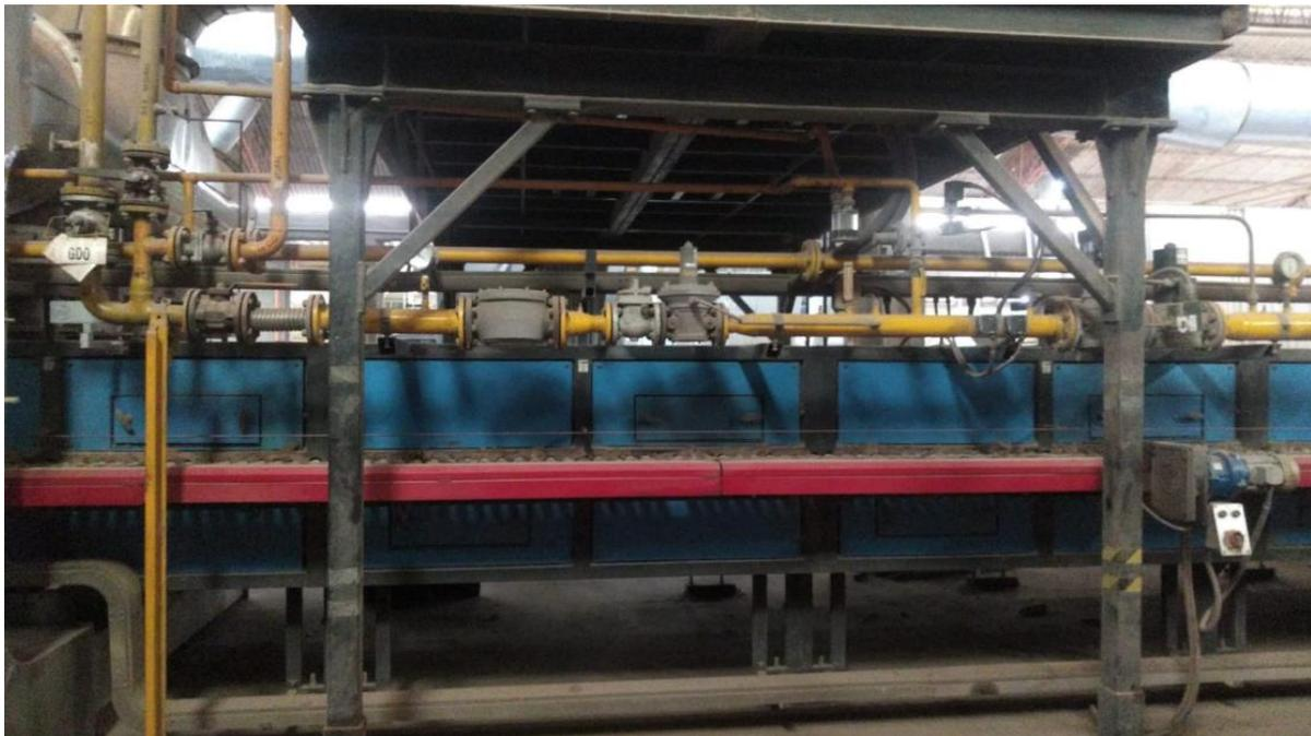
**Figura 18.** Centralita o rampa de gas Horno #5
