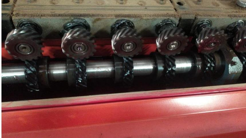
**Figura 15.** Engranajes helicoidales movimiento rodillos
