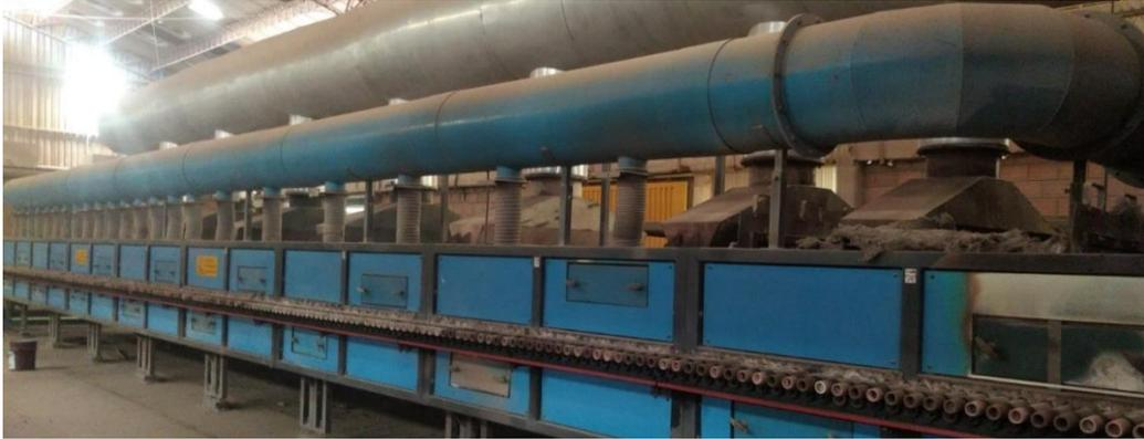
**Figura 45.** Enfriamiento final encima del plano de rodillos
