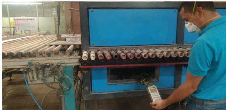
**Figura 67.** Toma de temperatura Salida del horno
