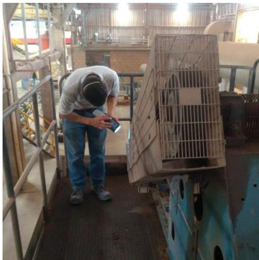
**Figura 52.** Toma de RPM de la relación del motor
