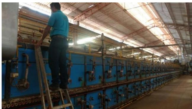
**Figura 60.** Toma de temperatura en el techo del horno
