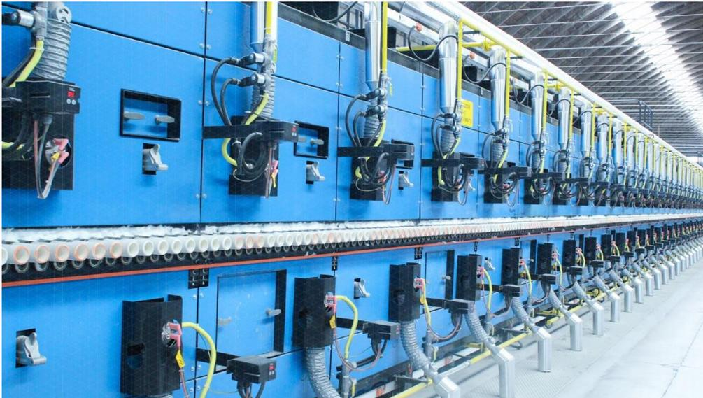
**Figura 4.** Horno de rodillos monoestrato
