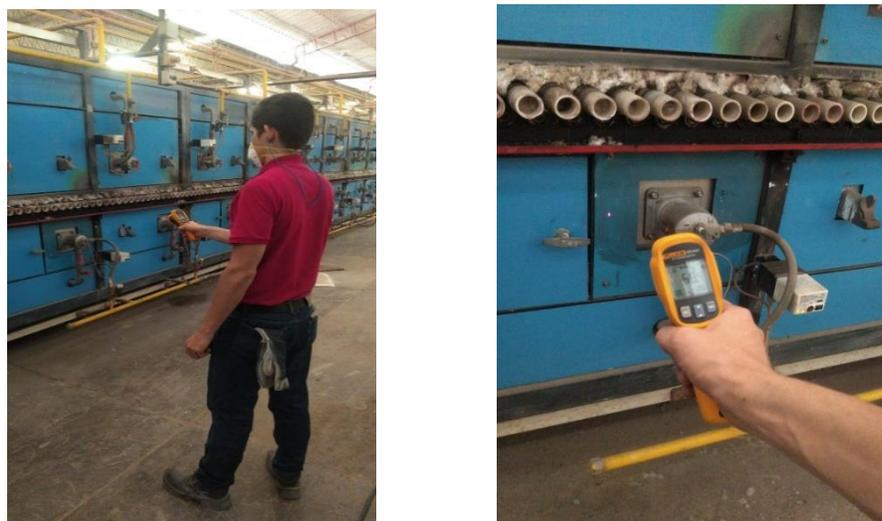
**Figura 58.** Toma de temperatura paredes del horno lado rodillos
