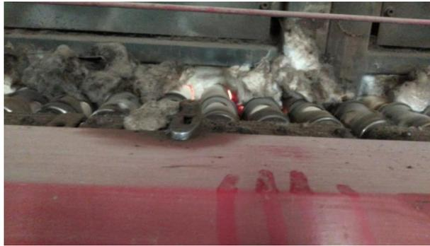
**Figura 75.** Mal aislado del plano de rodillos
