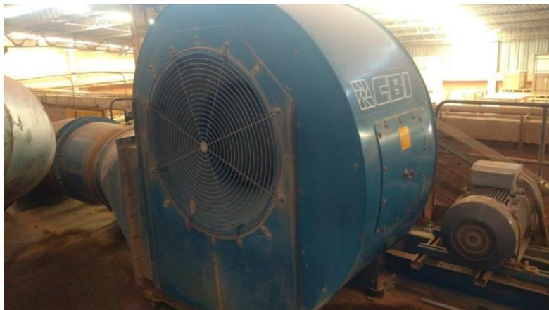
**Figura 47.** Ventilador de enfriamiento final
