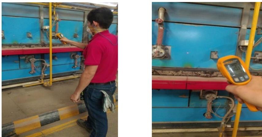
**Figura 59.** Toma de temperatura paredes del horno lado motorizado
