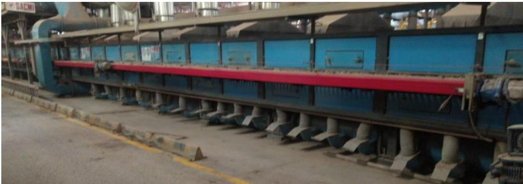
**Figura 46.** Enfriamiento final debajo del plano de rodillos
