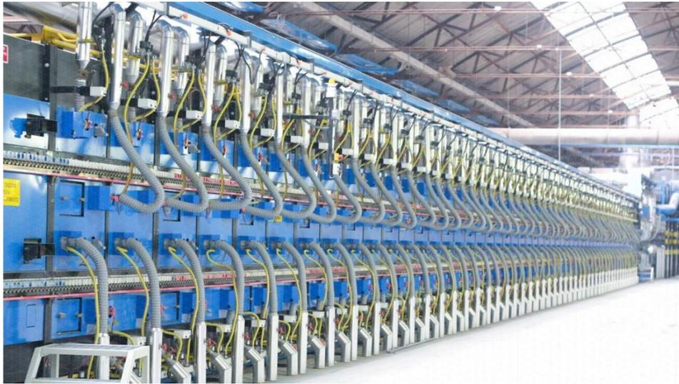
**Figura 5.** Horno de rodillos bicanal
