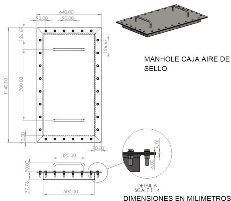
**Figura 17.** Plano técnico para construcción del MANHOLE.
