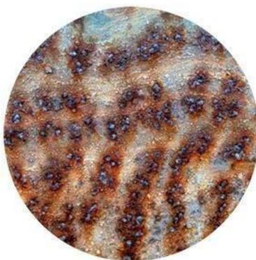
**Figura 2.** Corrosión por picadura.
