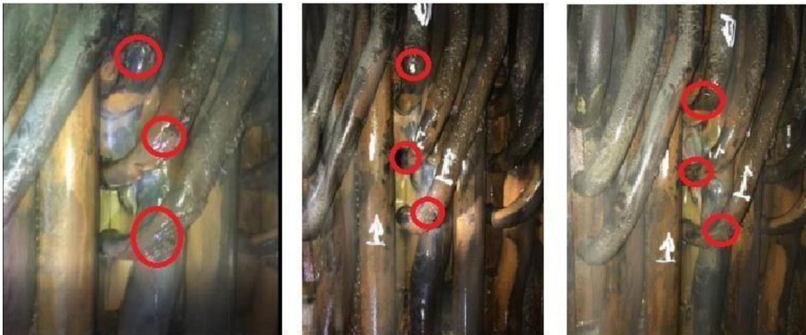
**Figura 1.** Erosión en la tubería.
