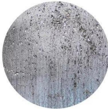
**Figura 3.** Corrosión por turbulencias.
