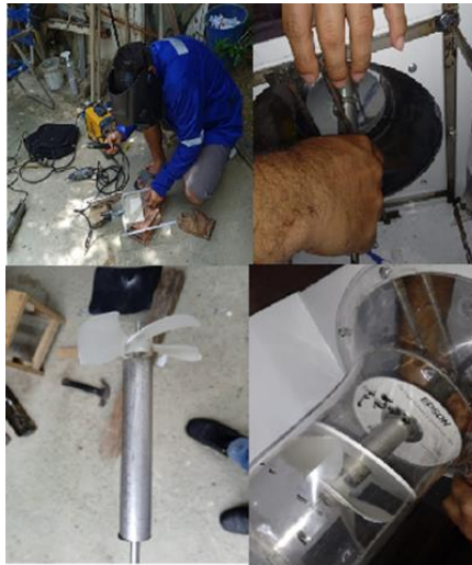
Figura 25. Construcción y balanceo del eje de la hélice
