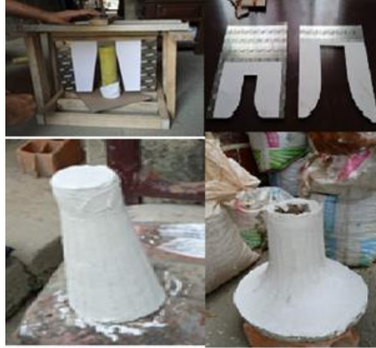
Figura 22. Proceso elaboración moldes en yeso.
