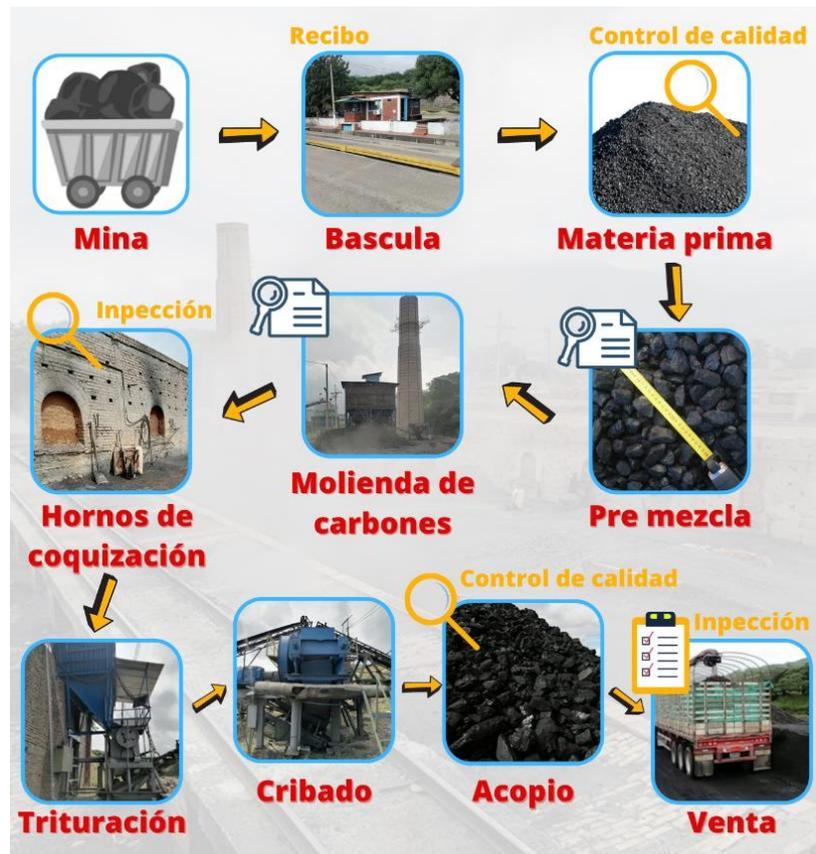
**Figura 24.** Esquema del proceso del coque.
