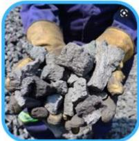
El **coque** contiene pocas impurezas y un alto contenido de carbono. Es el material carbonoso sólido derivado de la destilación destructiva de carbón bituminoso de bajo contenido de cenizas y bajo contenido de azufre.
