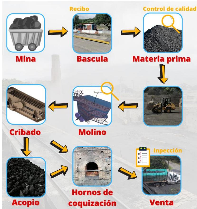
**Figura 22.** Proceso del carbón coquizable.
