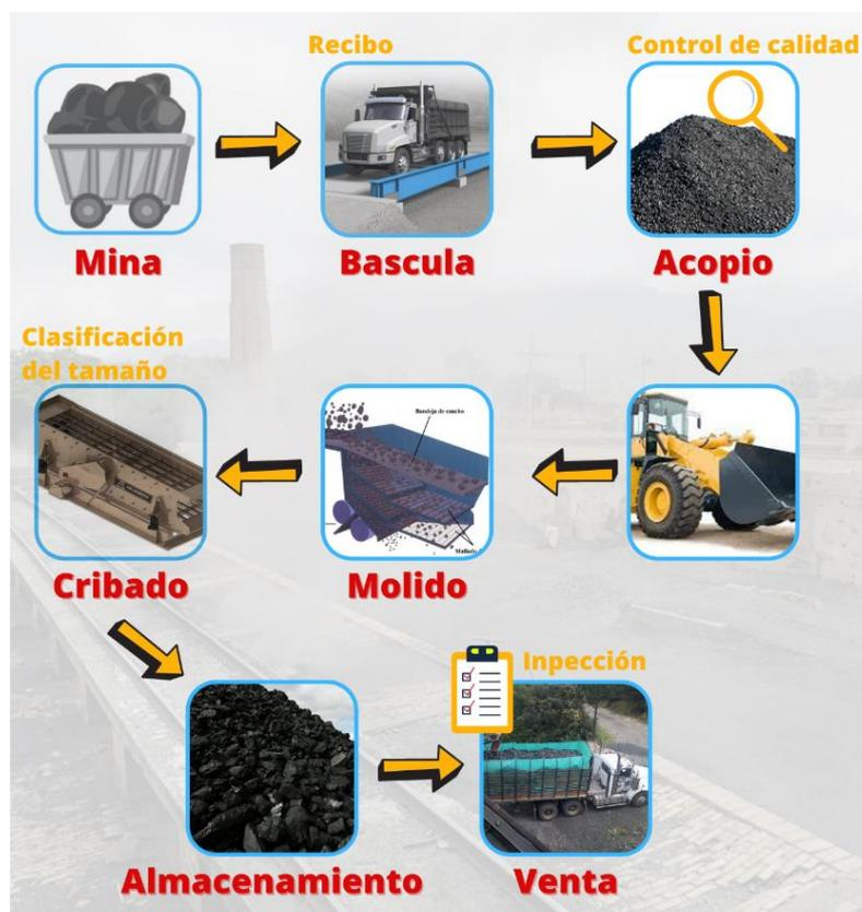
**Figura 20.** Proceso del carbón térmico.
