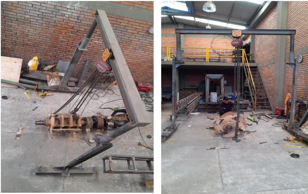
**Figura 1.** Grúa pórtico de una tonelada del taller de mantenimiento industrial Heros S.A.S
