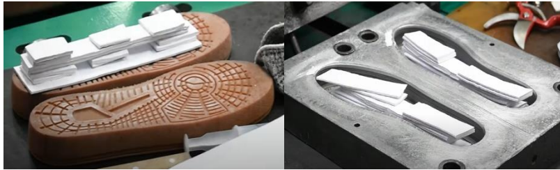
Figura 12. Proceso de relleno del molde.
