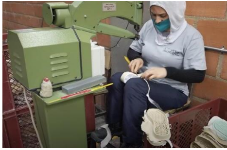
Figura 15. Retiro de rebaba manualmente.
