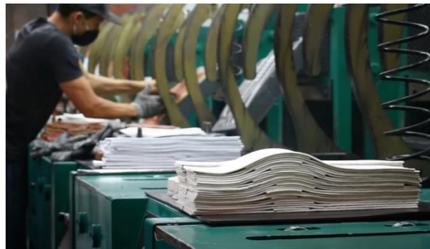
Figura 24. Vulcanización de un lote de suelas.
