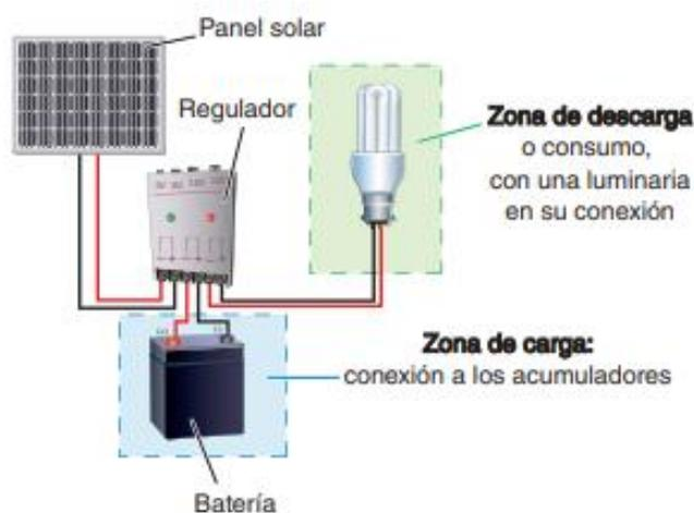
**Figura 21. Conexiones del regulador en una instalación fotovoltaica**
