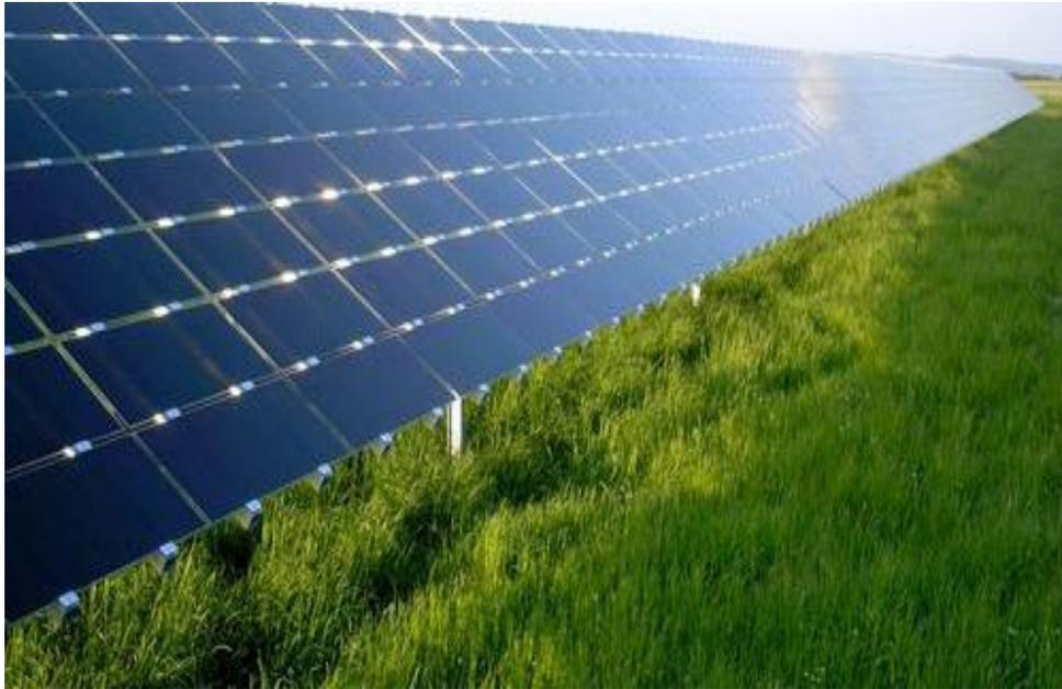
**Figura 9. Panel solar fotovoltaico de capa fina**
