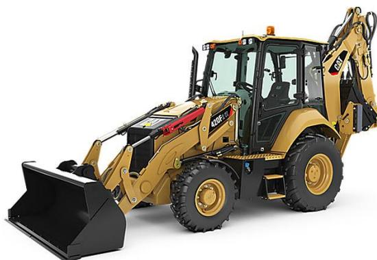
**Figura 8.** Retroexcavadora cargadora Caterpillar 420E
