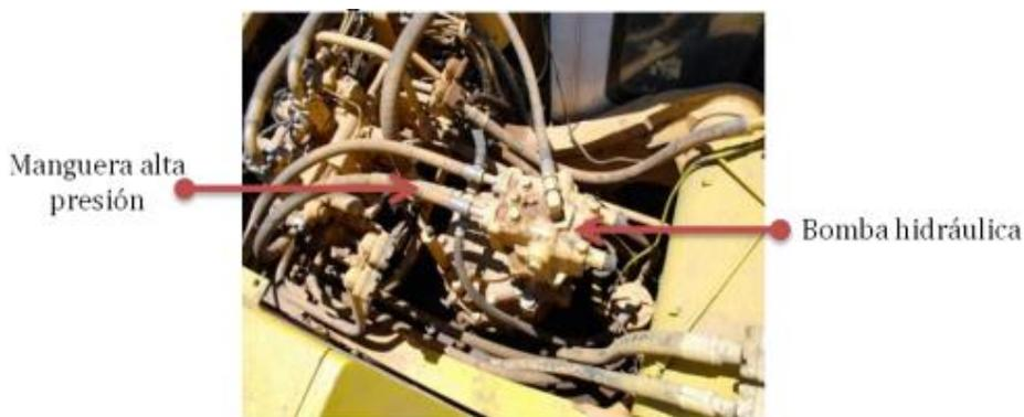
**Figura 3.** Sistema hidráulico
