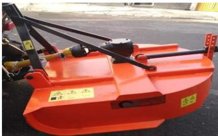
**MÁQUINA-EQUIPO:** CORTAMALEZA DE ALCE HIDRAULICO CATEGORIA
