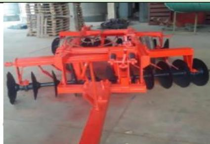
**MÁQUINA-EQUIPO:** RASTRA DESTERRONADORA 20discosX6mm
