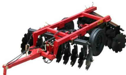
**MÁQUINA-EQUIPO:** RASTRA DESTERRONADORA 20discosX6mm
