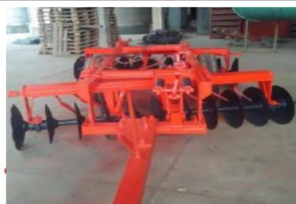
**MÁQUINA-EQUIPO:** RASTRA DESTERRONADORA 20discosX6mm
