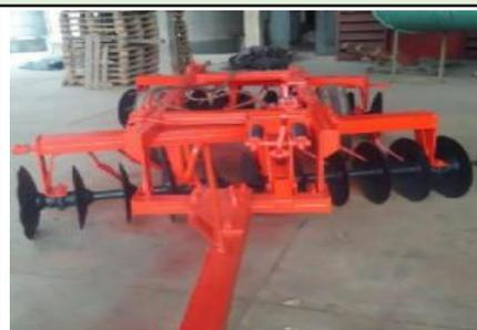
**MÁQUINA-EQUIPO:** RASTRA DESTERRONADORA 20discosX6mm
