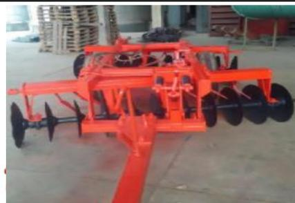
**MÁQUINA-EQUIPO:** RASTRA DESTERRONADORA 20discosX6mm
