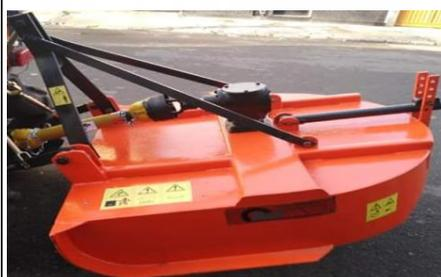
**MÁQUINA-EQUIPO:** CORTAMALEZA DE ALCE HIDRAULICO CATEGORIA
