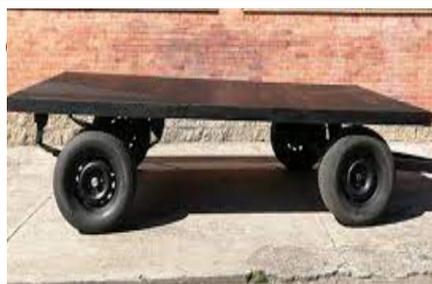
**MÁQUINA-EQUIPO:** REMOLQUE MULTIUSOS DE PLANCHON
