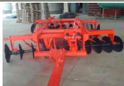
**MÁQUINA-EQUIPO:** RASTRA DESTERRONADORA 20discosX6mm
