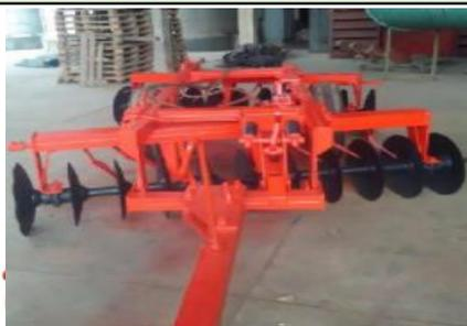
**MÁQUINA-EQUIPO:** RASTRA DESTERRONADORA 20discosX6mm
