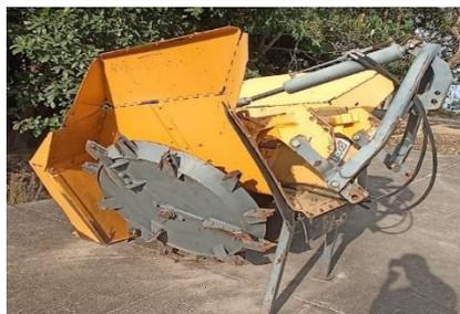
**MÁQUINA-EQUIPO:** ZANJADORA ROTATIVA
