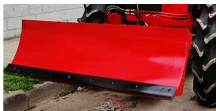
**MÁQUINA-EQUIPO:** CUCHILLA DELANTERA 2,4mX60cm
