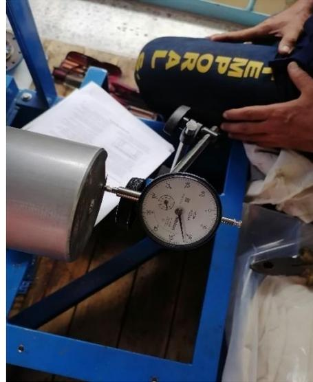
El procedimiento resulta adecuado en el movimiento del eje lo que hace que el rotor pueda girar, una vez el rotor libre se procede a devolver el eje axialmente tal lo indicado en el manual.
