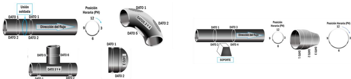
Figura 11. Scan B en tramos rectos y en accesorios.
