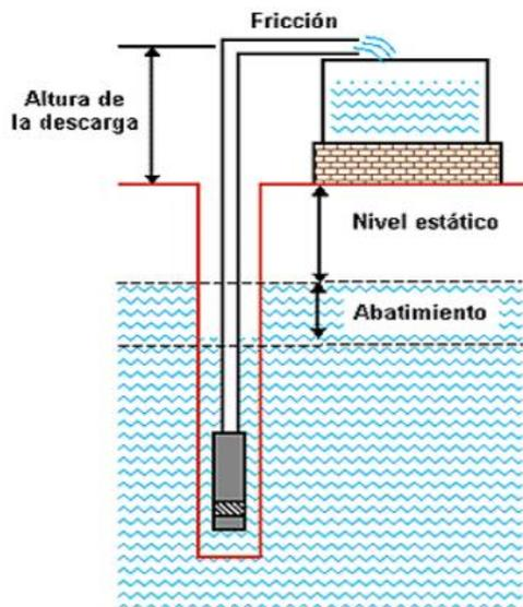
**Ilustración 4. Principales componentes hidráulicos de un sistema de bombeo de agua**
