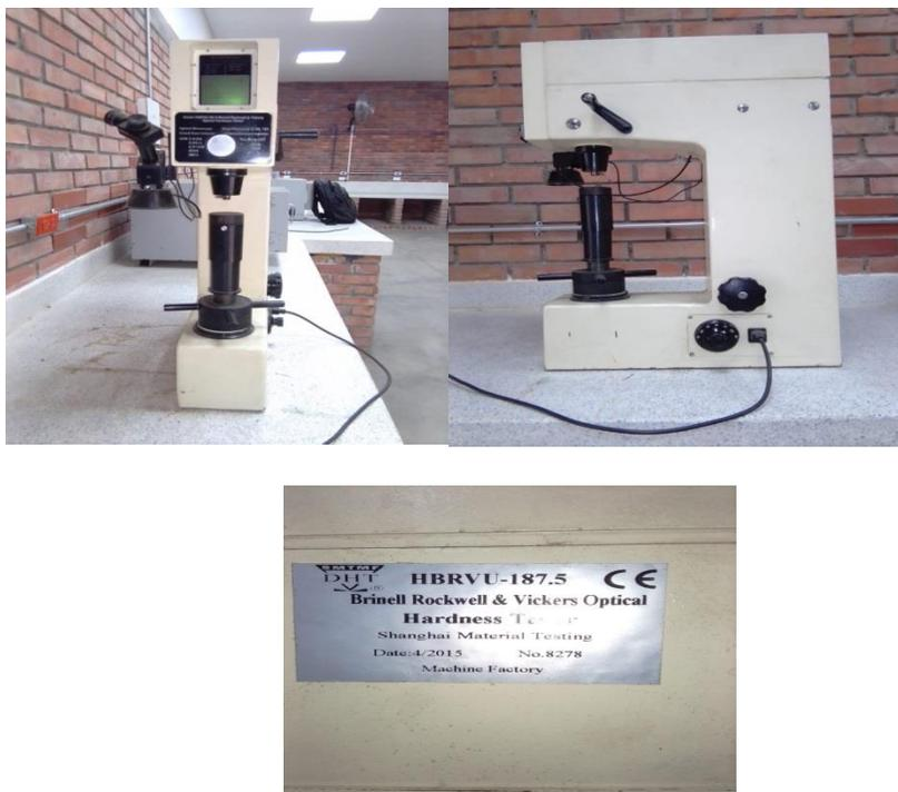
Figura 11. Durómetro
