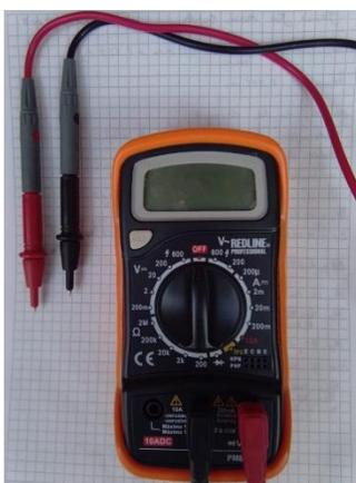
Figura 16. Multímetro digital
