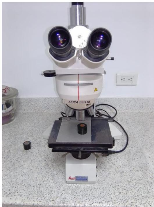
Figura 9. Microscopio Leica DM LM
