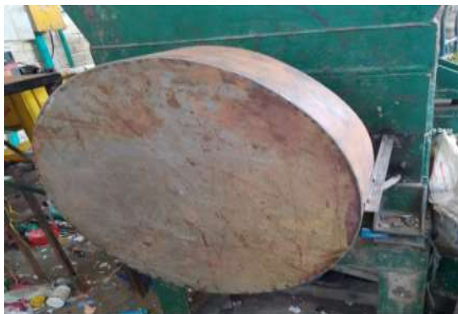
Ilustración 10. Cubierta polea para PPLC-ZPM-PM-SM-002
