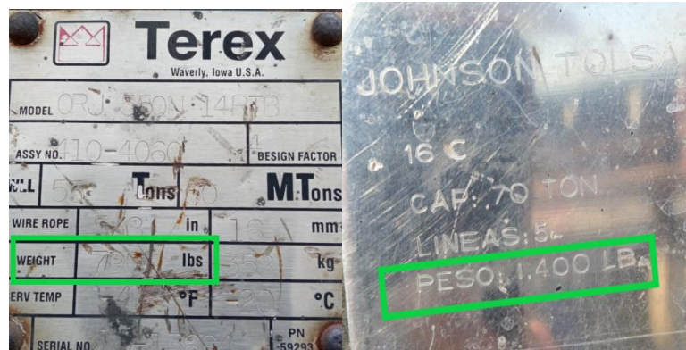
ILUSTRACIÓN 10. PESOS DEL BLOQUE DE IZAJE QUE SE DEBE TENER EN CUENTA PARA LA DETERMINACIÓN DE LA CARGA NETA (FOTO TOMADA POR EL ESTUDIANTE).
