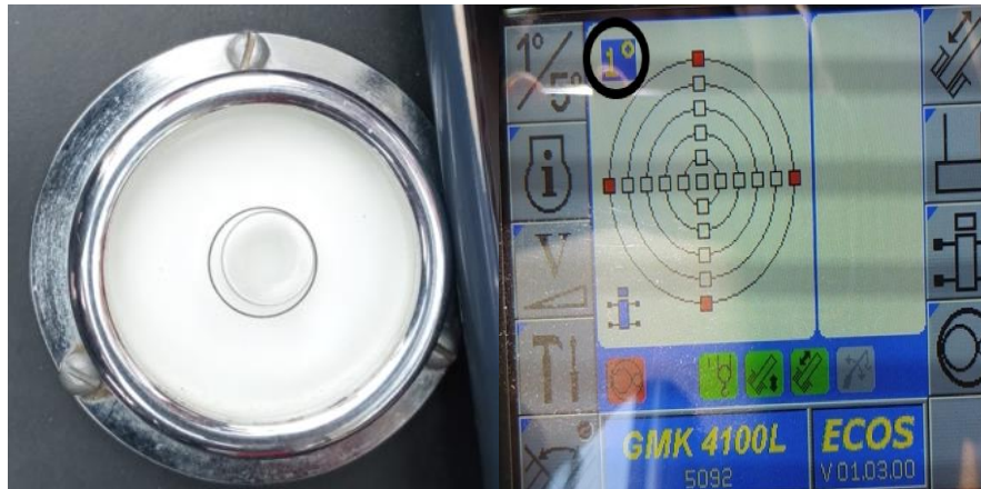
ILUSTRACIÓN 9. EJEMPLOS DE INDICADORES DE NIVELACIÓN DE LA GRÚA (FOTOS TOMADA POR EL ESTUDIANTE)
