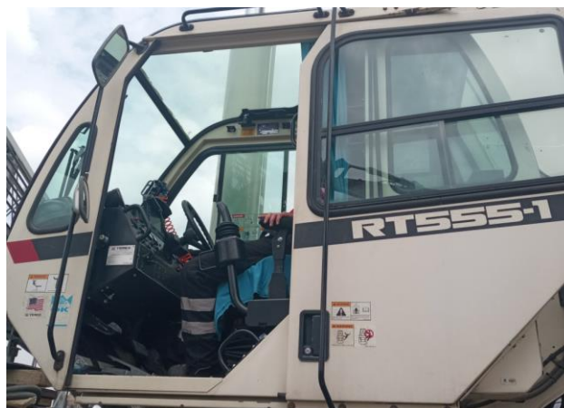
ILUSTRACIÓN 15. CABINA SIN DEFORMACIONES O VIDRIOS ROTOS QUE IMPOSIBILITEN LA VISIBILIDAD DEL OPERADOR (FOTO TOMADA POR EL ESTUDIANTE).
