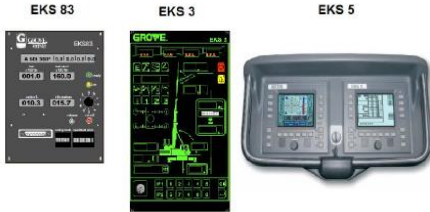
Fig 2. LMI Grove GMK: EKS: Elektronik Kran System
