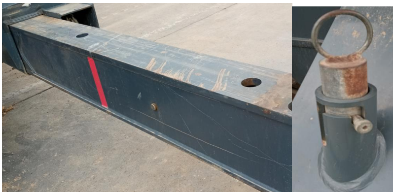
ILUSTRACIÓN 16. VIGAS ESTABILIZADORAS DEBIDAMENTE MARCADO Y CON FUNCIÓN DE BLOQUEO HORIZONTAL OPERATIVO (FOTO TOMADA POR EL ESTUDIANTE).
