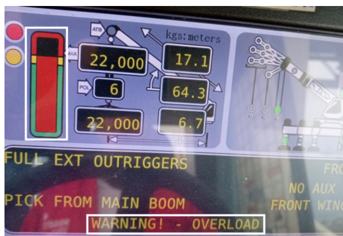
ILUSTRACIÓN 19. SEÑAL DE ALERTA POR SOBRECARGA EN UN LMI MARCA GREER ELEMENT (FOTO TOMADA POR EL ESTUDIANTE).
