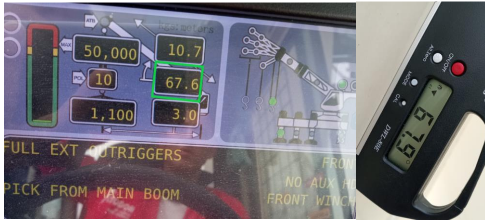
ILUSTRACIÓN 22. VERIFICACIÓN DEL ÁNGULO (FOTO TOMADA POR EL ESTUDIANTE).
