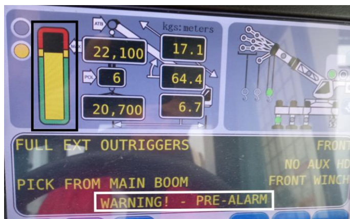
ILUSTRACIÓN 18. SEÑAL DE APROXIMACIÓN A SOBRECARGA (PREALARMA) EN UN LMI MARCA GREER ELEMENT (FOTO TOMADA POR EL ESTUDIANTE).
