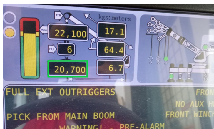
ILUSTRACIÓN 20. CARGA NOMINAL INDICADA POR UN LMI MARCA GREER ELEMENT (FOTO TOMADA POR EL ESTUDIANTE).
