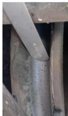
ILUSTRACIÓN 13. MEDICIÓN DE LAS RANURAS DE LAS POLEAS (FOTO TOMADA POR EL ESTUDIANTE).
