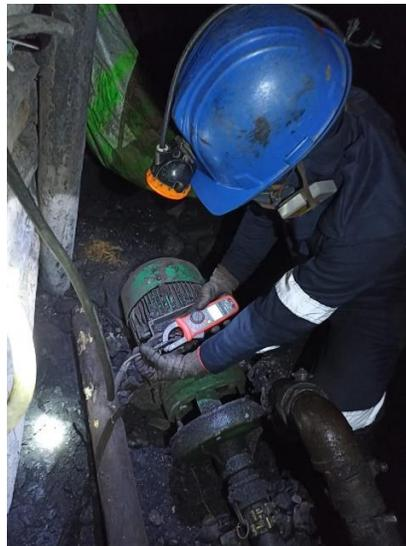
**Figura 19. Medida de variables eléctricas en la mina San Tomas**
