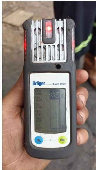
**Figura 23. Dräger X-am 5600 indicando una alarma**
