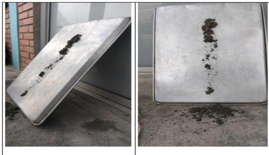
El valor obtenido a través de la prueba es de 50 grados de inclinación, se considera que, para asegurar un flujo constante de material, se aumentará  $10^{\circ}$  más de inclinación. Ver la Figura 81
