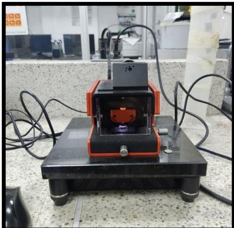
Figura 13 Equipo NaioAFM para análisis de Rugosidad.
