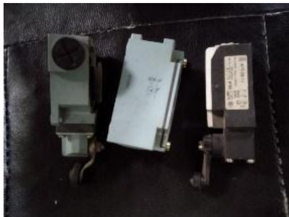
Figura 43. Contactos de reposición automática y manual para paracaídas, guayas, finales de carrera, limitador polea tensora y puertas de emergencia
