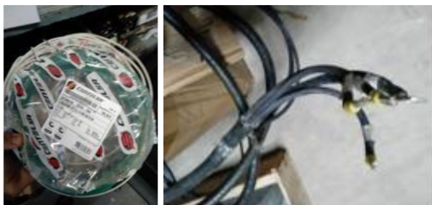
Figura 32. Cable eléctrico de control para fuerza según hp del motor para el control generalmente awm 18 (0.85mm 2 )
