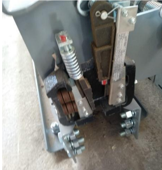
Figura 16. Caja cuñas de acción progresiva
