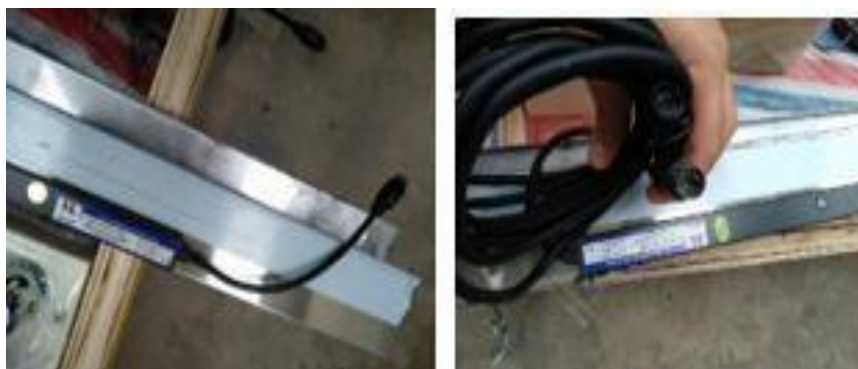
Figura 44. Focélula de rayos múltiples, cortina de rayo infra-rojos
