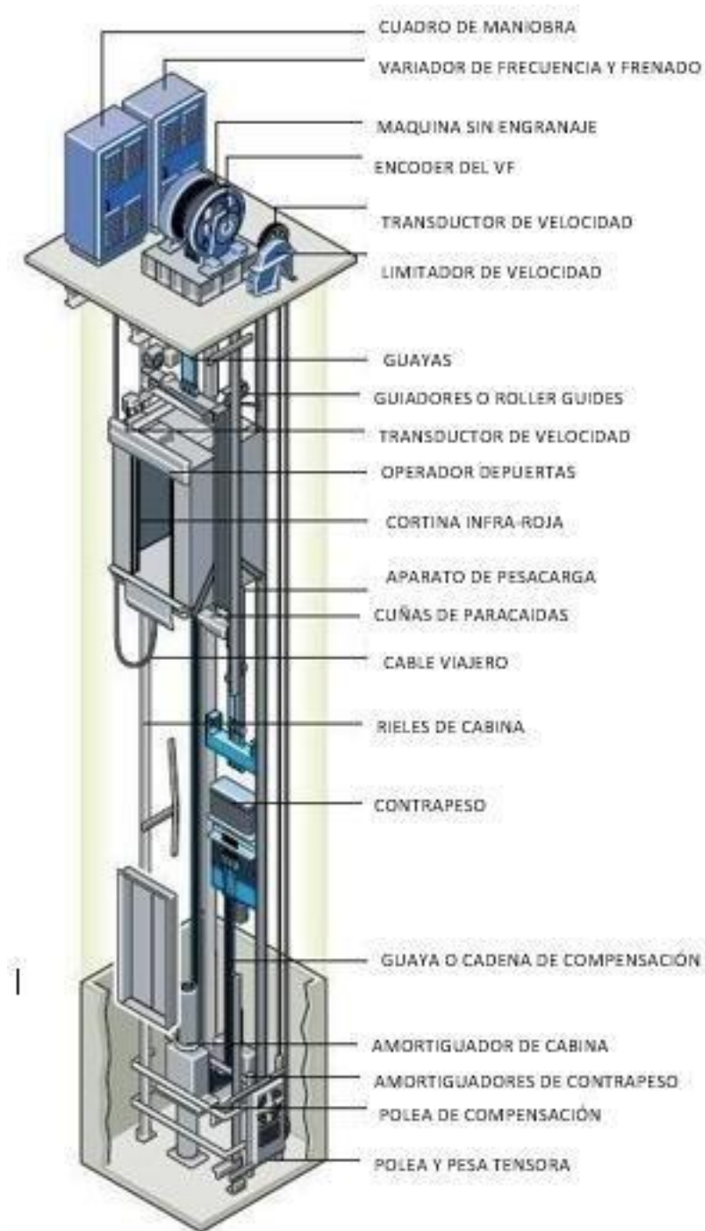
Figura 47. Ascensor con cuarto de máquinas
