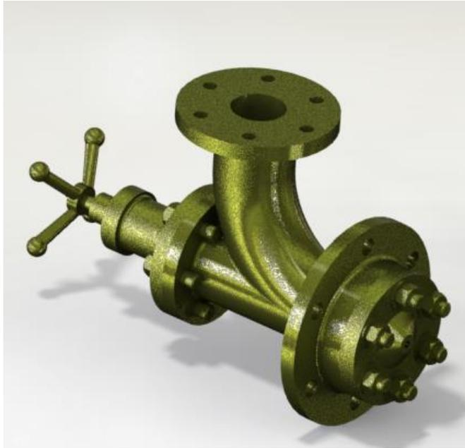
**Figura 37.** Codo a 60° más sistema de regulación de la tobera de la microcentral hidroeléctrica
