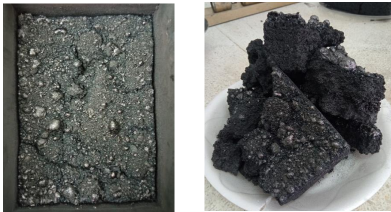
Figura 13. Muestra final a 550°C en rampa de sostenimiento de una hora.
