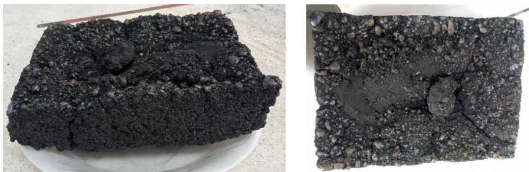
Figura 17. Muestra final a 500°C en rampa de sostenimiento de media hora.
