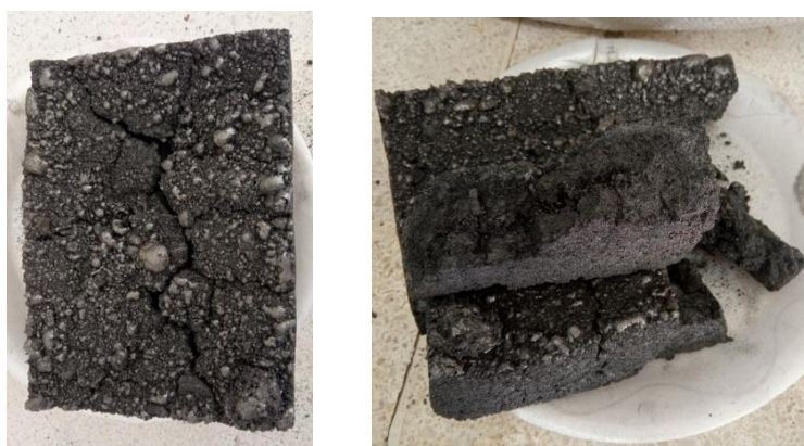
Figura 21. Muestra final a 700°C en rampa de sostenimiento de media hora.
