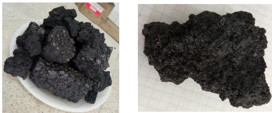
Figura 18. Muestra final a 550°C en rampa de sostenimiento de media hora.
