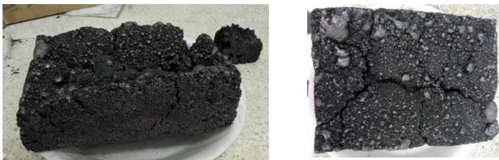
Figura 20. Muestra final a 650°C en rampa de sostenimiento de media hora.
