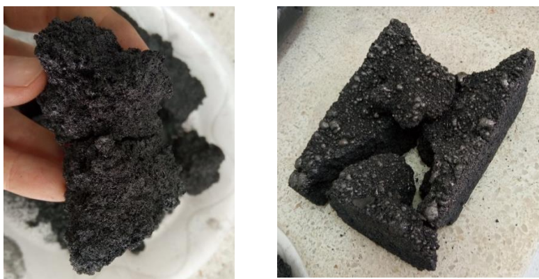
Figura 14. Muestra final a 600°C en rampa de sostenimiento de una hora.
