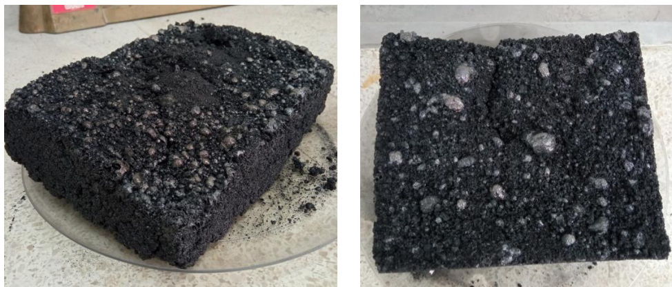
Figura 12. Muestra final a 500°C en rampa de sostenimiento de una hora.
