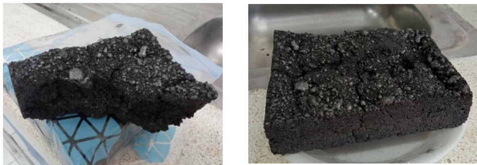
Figura 16. Muestra final a 700°C en rampa de sostenimiento de una hora.
