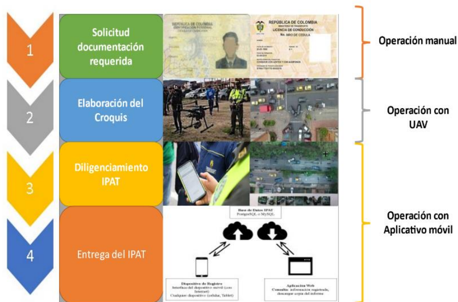
Ilustración 52 Proceso de recolección y levantamiento de información con apoyo de tecnología
