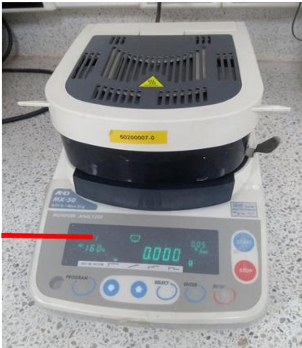
Anexo 1. Balanza para la toma de % de humedad del material
