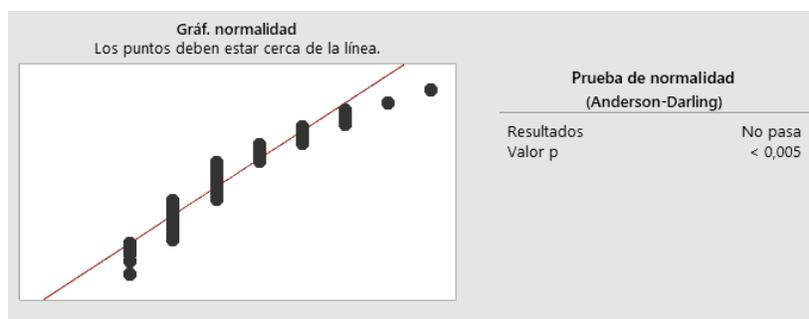
**Ilustración 63.** Prueba de normalidad de la viscosidad del Engobe B
