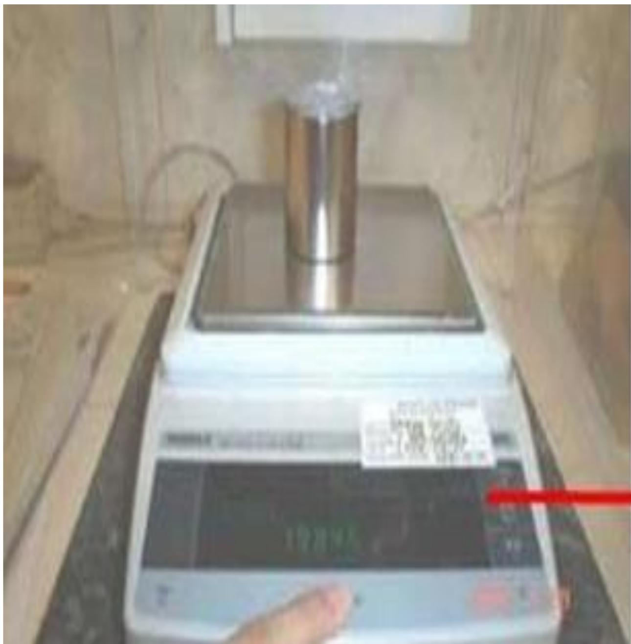
**Anexo 3.** La toma de densidad se realiza con picnómetro y la balanza
