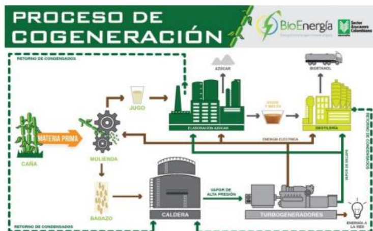
Figura 51. Proceso de Cogeneración a través de caña de azúcar. Fuente: Asocaña 2017
