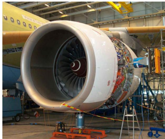
Figura 2. Distribución por posición fija: ensamble de un avión airbus en la planta de Airbus en Toulouse
