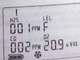
Falla de datos del sensor
