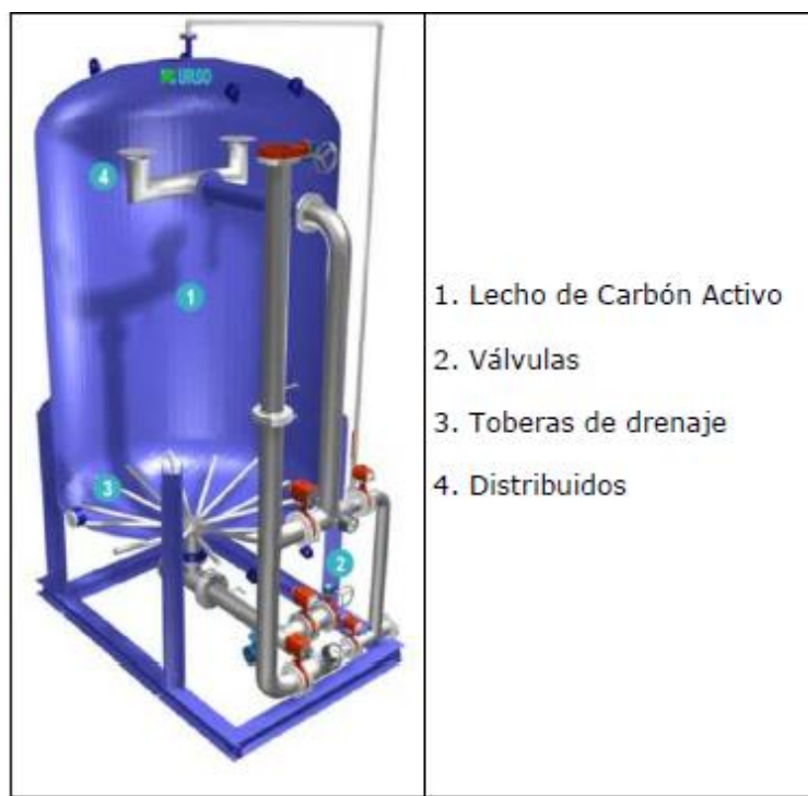
Figura 30. Esquema para el tratamiento de agua con carbón activado granular.
