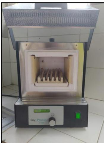
**Figura 14. Secado en la mufla eléctrica Ney VULCAN D-130**
