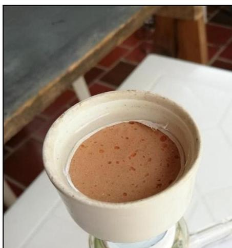
**Figura 19. Membrana cerámica dentro del embudo buchner**
