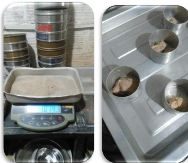
Figura 12. Material que pasa el tamiz N°200 Límite Plástico
