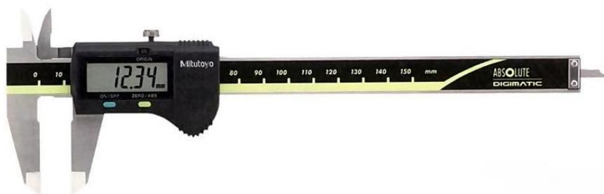
**Figura 12.** Pie de Rey Digital de 200 mm
