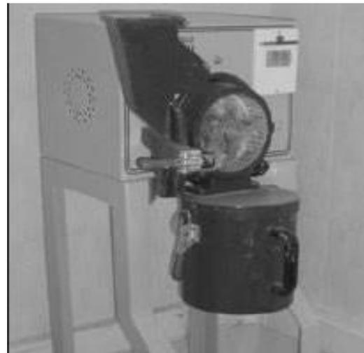
**Figura 8.** Molino de Martillos (Molienda
