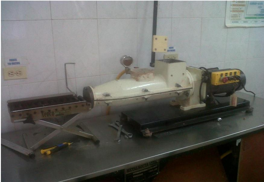
**Figura 6.** Extrusora de Laboratorio con Vacío
