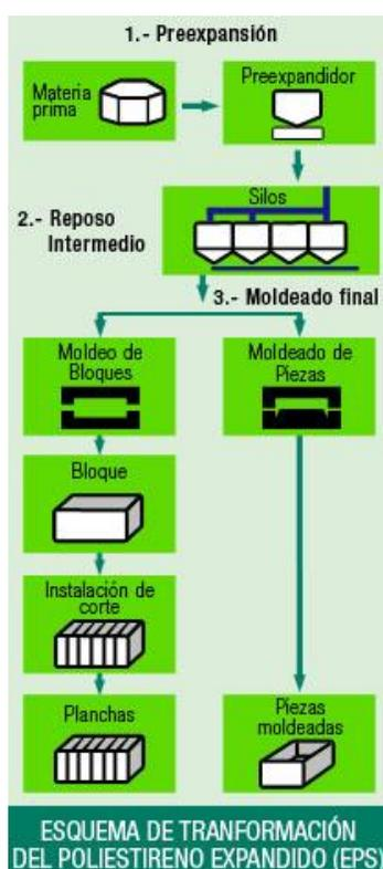
**Figura 2.** Proceso de Transformación del Poliestireno Expandible
