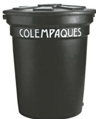
**Figura 14.** Tanque para realizar Absorción de Agua por el Método de Inmersión
