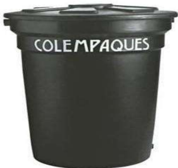
Figura 10. Tanque para realizar absorción de agua por el método de inmersión. Fuente. S.f. (2022)
