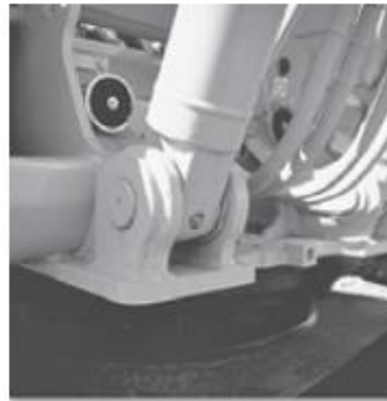
Este pasador se usa para soportar el extremo de un tirante usado en un tractor.
