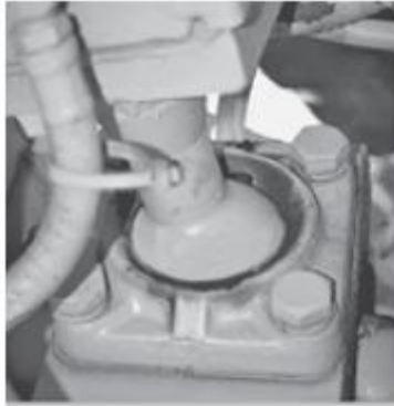
Esta junta de rótula esférica proporciona una conexión para la caja de una máquina niveladora de tierra con su bastidor. (4)
