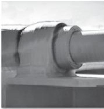
Esta chumacera de empuje se usa para soportar la flecha impulsora de una máquina. (7)
