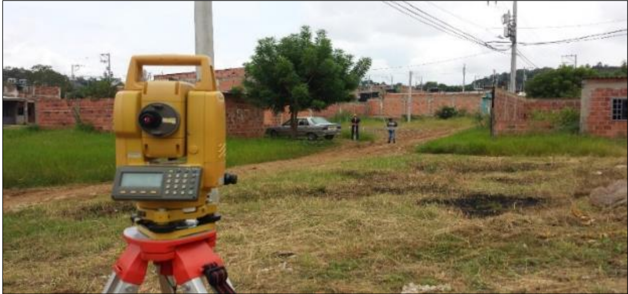
Figura 3. Estación total marca topcon GTS 245.
