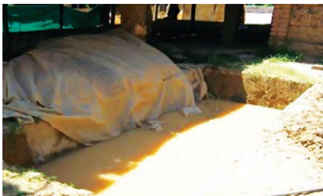
Figura 4. Humectación de la Arcilla
