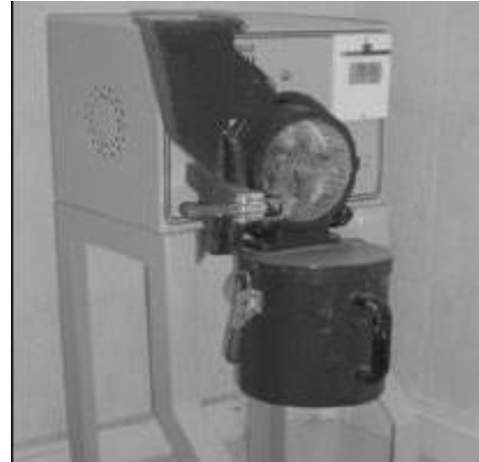
Figura 16. Molino de Martillos (Molienda Vía Seca)
