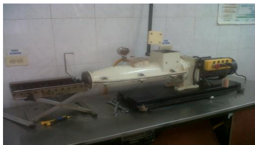
Figura 14. Extrusora de Laboratorio con Vacío
