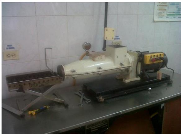
**Figura 12.** Extrusora de Laboratorio con Vacío
