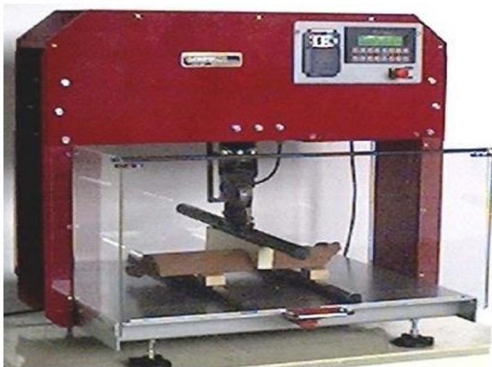
**Figura 22.** Crometro (Prensa de Presión)
