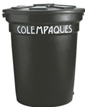
Figura 19. Tanque para realizar Absorción de Agua por el Método de Inmersión
