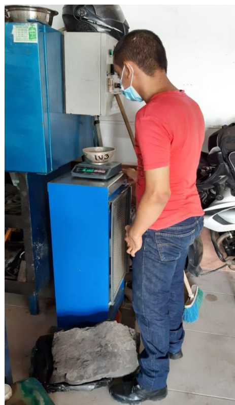
Fotografía 46. Peso del material Tamizado, rio pamplonita
