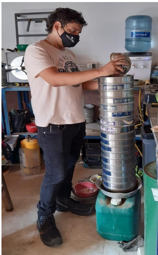
Fotografía 40. Tamizaie del material granular. rio zulia
