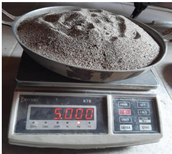
Fotografía 36. Peso del material granular, rio zulia
