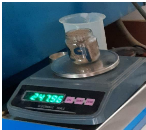
Fotografía 43. Peso material granular, rio pamplonita
