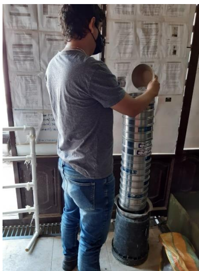
Fotografía 34. Tamizaje del material granular, rio peralonso
