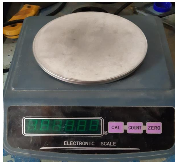
Fotografía 25. Balanza con sensibilidad de 0.01gf y capacidad de hasta 1000gramos
