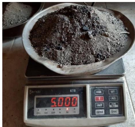
Fotografía 30. Peso del material granular, rio peralonso
